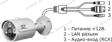
Рис. 1 Схема подключения видеокамеры
