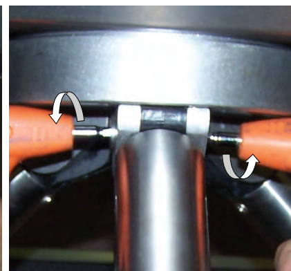
3. Затяните винты (шестигранник 5 мм)
