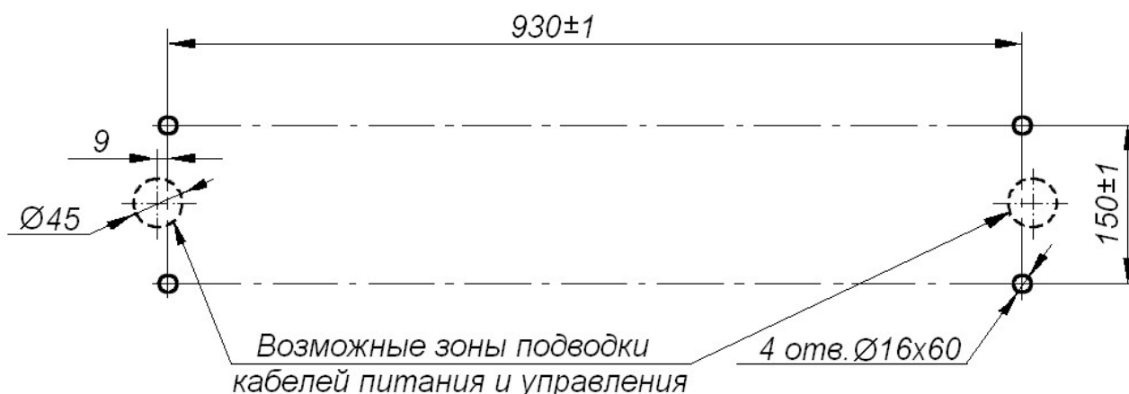
Рисунок 11. Схема разметки отверстий для крепления стойки турникета 1
